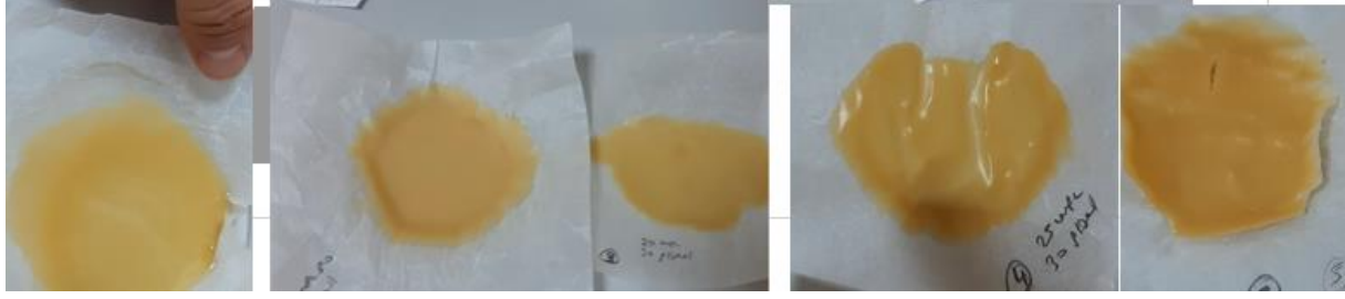
Şekil 5. Farklı miktarlardaki polimer ve plastikleştirici madde kullanımı ile elde edilen yenilebilir filmler
