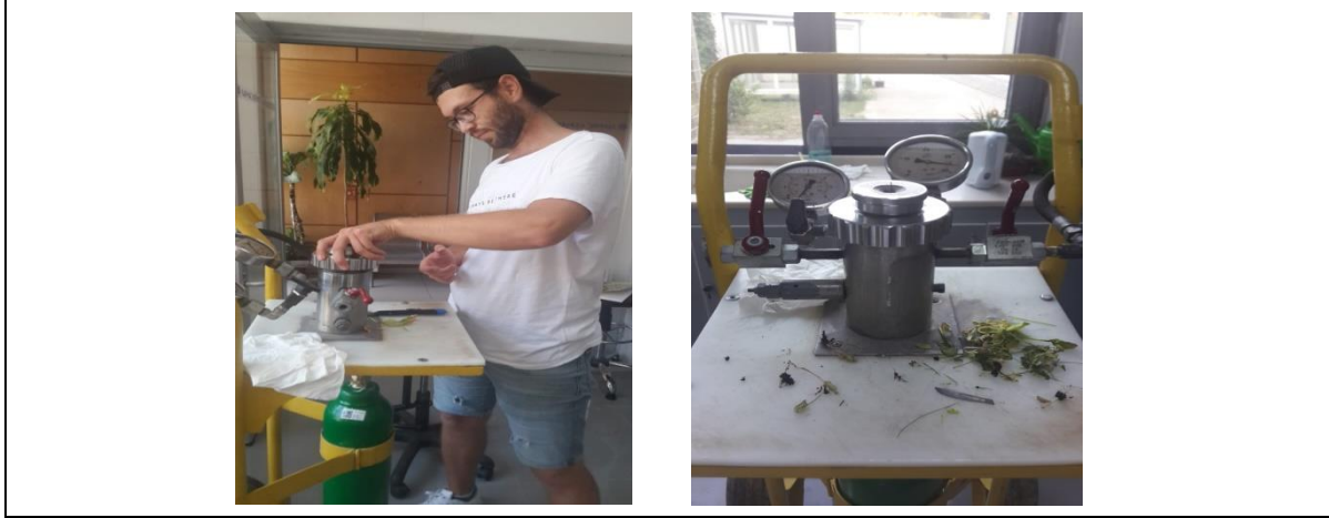
Şekil 0. Yaprak su potansiyelinin Scholander basınç odası ile ölçülmesi
