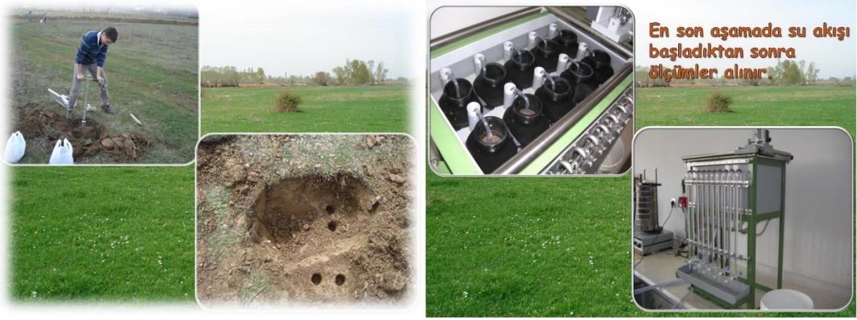
Şekil 2. Bozulmamış toprak örneklerinin alınması ve laboratuvarında doymuş koşullarda hidrolik ölçümünde kullanılan geçirgenlik ölçer aleti
