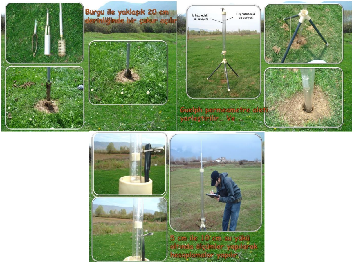
Şekil 1. Arazide doymuş koşullarda hidrolik iletkenlik ölçümü
