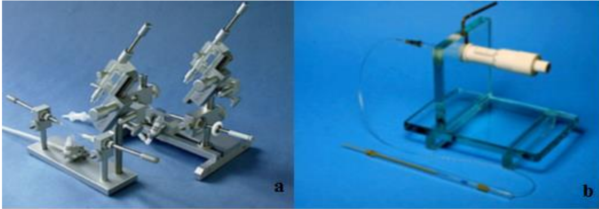
Şekil 2. Mikro vidalı şırınga düzeneği(a), Harbo şırınga(b) (Cobey, 2013)
